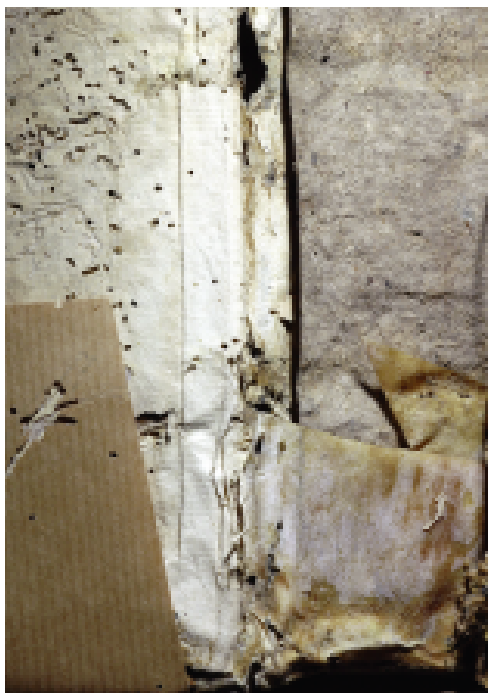
Fig. 3 — Fori di sfarfallamento e gallerie larvali di G. pubens (particolare).
